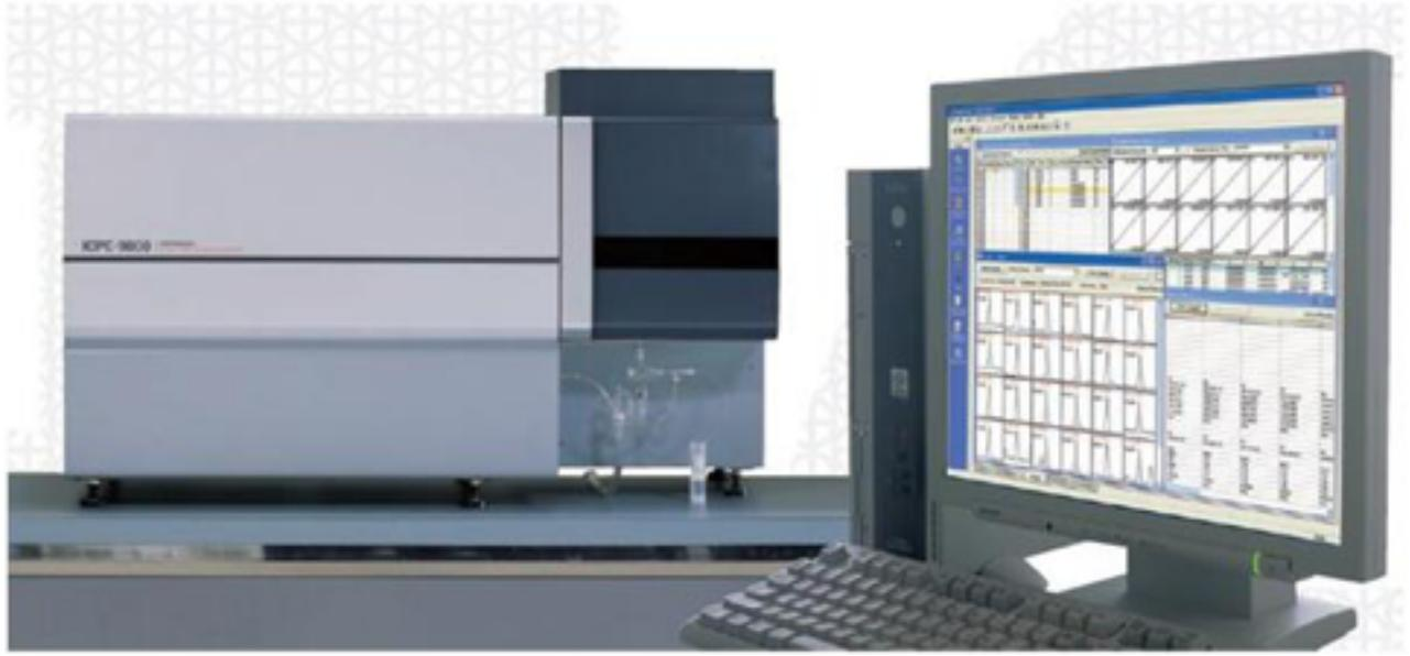
Le spectromètre d'émission optique avec plasma à couplage inductif permet d'effectuer des analyses multi élémentaires en simultané pour plus de 20 éléments à la fois. Sa rapidité et la fiabilité des résultats obtenus en font l'instrument incontournable pour :
